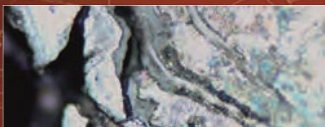
Nepřípustné: nehomogenní struktura odlitku (neodpovídající požadavku Zimmermann)
