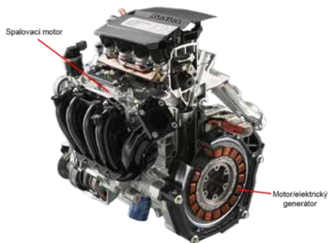
Mechanika paralelního hybridního vozidla (motor vozidla Honda Civic IMA)
